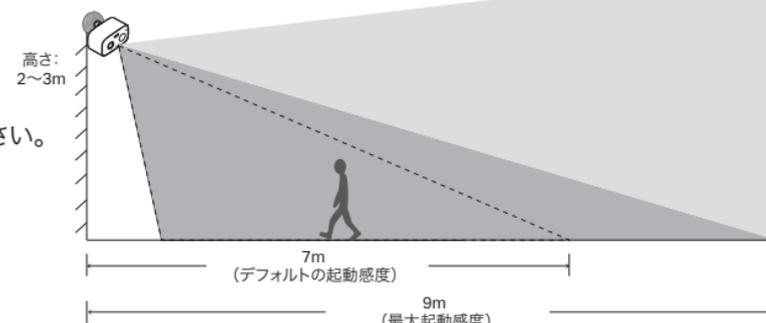
\*Tapoアプリを起動し、デバイス設定 > 検知 > 起動感度の順に進むと、起動感度を調整できます。上図の視野角およびPIR検知ゾーンは、カメラを地上から2.2mの高さに設置した場合のもです。
